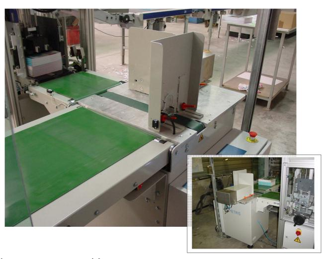
Le déviateur MT 512 est un élément autonome indispensable pour le changement de sens de piles en entrée de fardeleuse ou de palettiseur.
