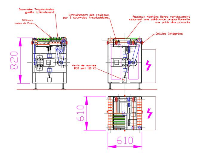
Le déviateur MT 513 est un élément autonome indispensable pour la gestion de flux de livres ou piles en provenance ou en direction de plusieurs machines. Selon son montage il peut gérer plusieurs entrées ou sorties automatiquement sur simple information électrique en toute compatibilité avec la plupart des installations (contacts sec aval).
